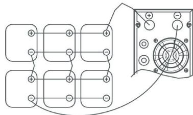
Рисунок 4. Подключение модели 2000
