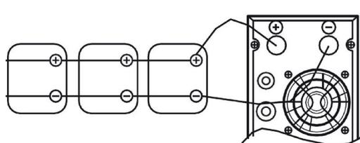
Рисунок 3. Подключение модели 600
