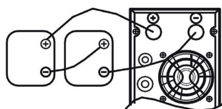
Рисунок 2. Подключение модели 2000
