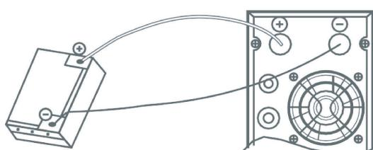
Рисунок 1. Подключение модели 600
